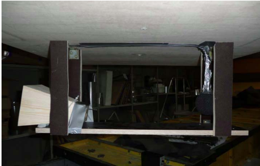
Bild 4.9 Die durchschlagende Zunge mit Trichter ohne Resonator wird in den „großen Windkanal“ einmontiert
