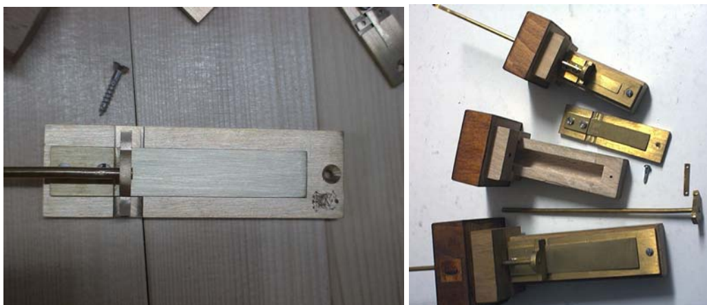
Bild 3.10 Durchschlagende Zungen (Foto: Henry Güntzel)
