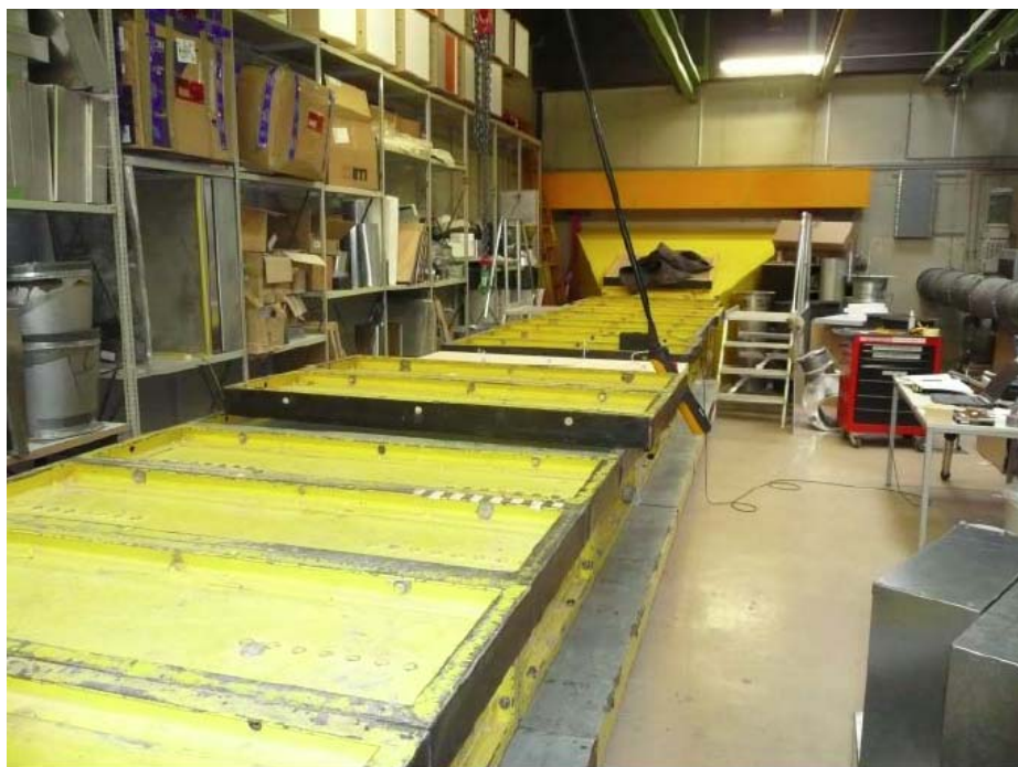
Bild 4.2 „Großer Windkanal“ (Schalldämpferprüfstand des IBP) für die Simulation der strömungsakustischen Umstände von einem Windrad (ausführliche technischen Daten sind in der Anlage 2 angegeben). Oben: Längsschnittzeichnung Unten: Photo
