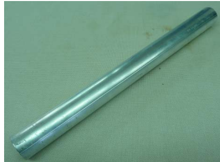
Bild 3.2 Einfaches, auf einem Ende geschlossenes Metallrohr, als akustischer Resonator
