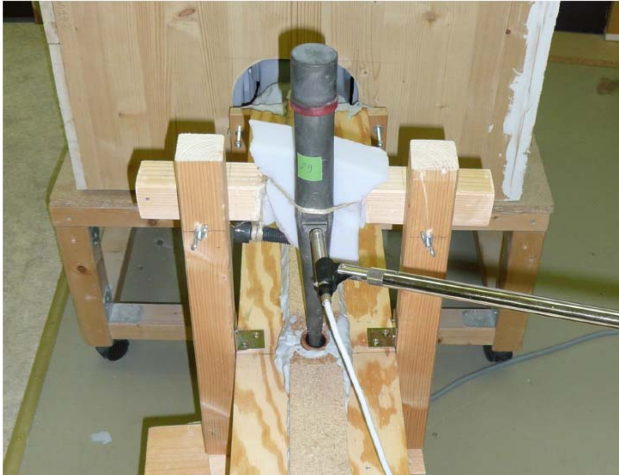
Messung mit einer gedackten Pfeife
