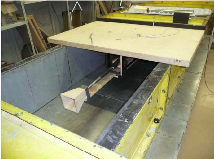
Bild 4.11 Die durchschlagende Zungenpfeife (mit Resonator) und mit Trichter im „großen Windkanal“
