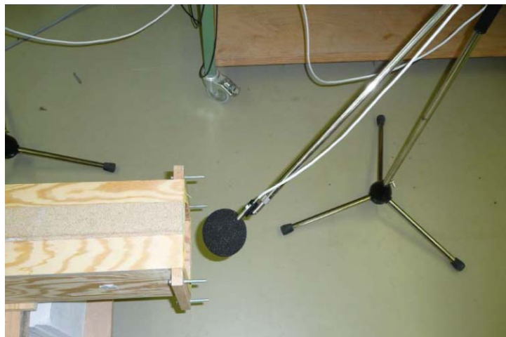
Bild 4.3 Geräuschemessung am Ende des „einfachen Windkanals“ mit einem Windschutz am Mikrophon
