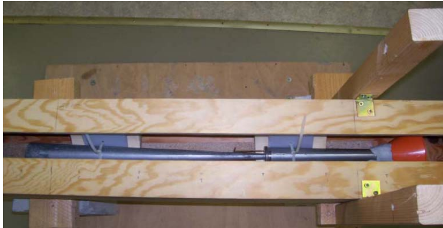
Bild 4.7 Eine Zungenpfeife vorbereitet für die Messung im „einfachen Windanal“
