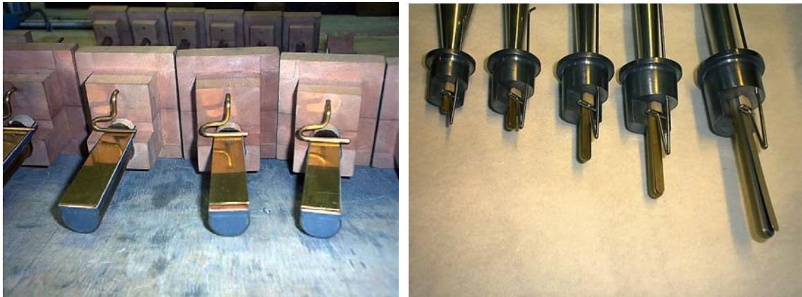
Bild 3.9 Aufschlagende Zungen (Foto: Henry Güntzel)
