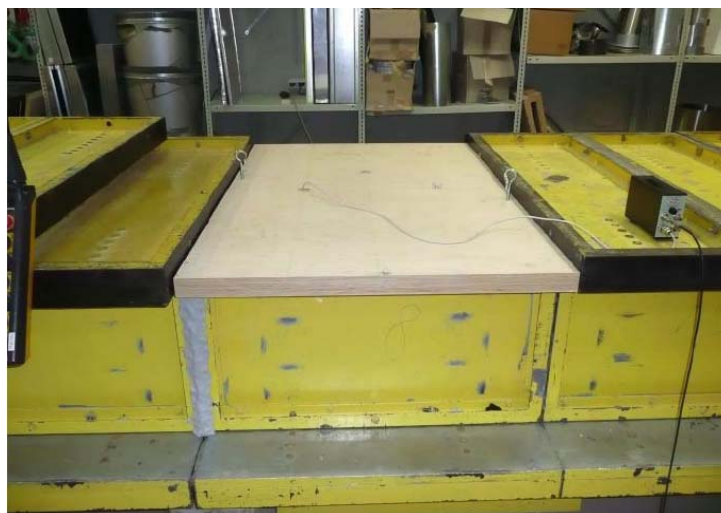
Bild 4.4 Grundgeräuschemessung im „großen Windkanal“ (das Mikrophon befindet sich im Kanal)
