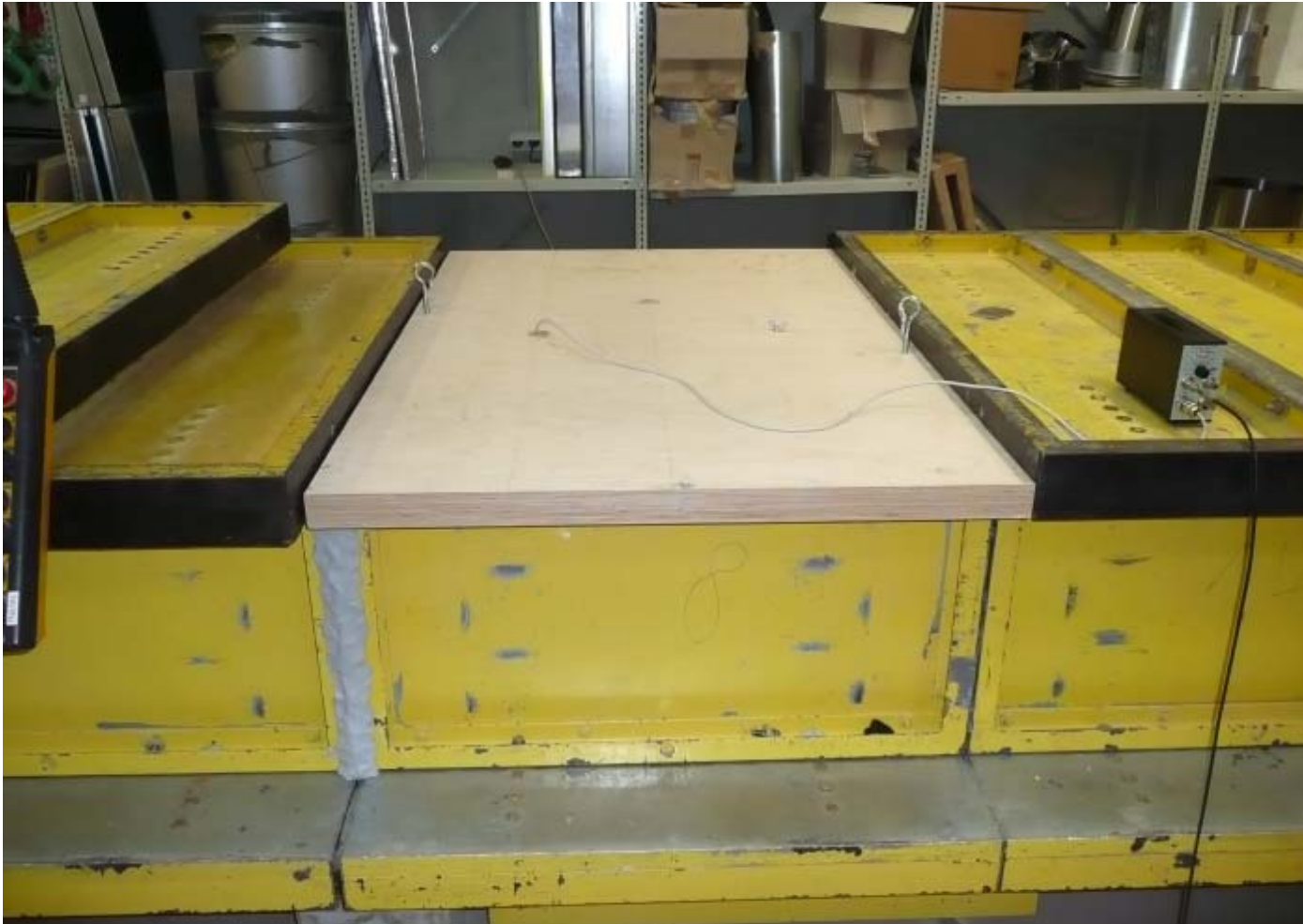
Grundgeräusch Messung im großen Windkanal
