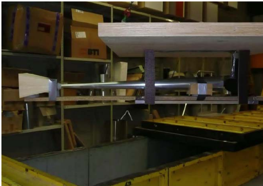
Bild 4.10 Die durchschlagende Zungenpfeife (mit Resonator) und mit Trichter wird in den „großen Windkanal“ einmontiert
