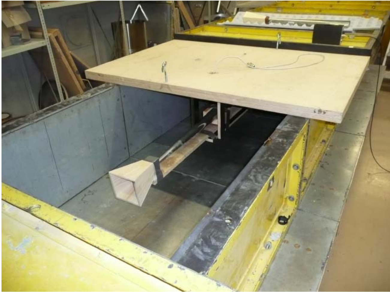
Die durchschlagende Zungenpfeife (mit Resonator) und mit Trichter im großen Windkanal
